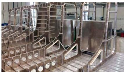
*Als erstes W.D.R.-Schiff überhaupt besteht die doppelrümpfige „Rüm Hart“ aus Aluminium – ein anspruchsvoller Werkstoff, der in einem extrem sauberen Umfeld verbaut werden muss. Gefertigt wurde der Rumpf bei einem Zulieferbetrieb der Bauwerft TB Shipyards im niederländischen Makkum.*
